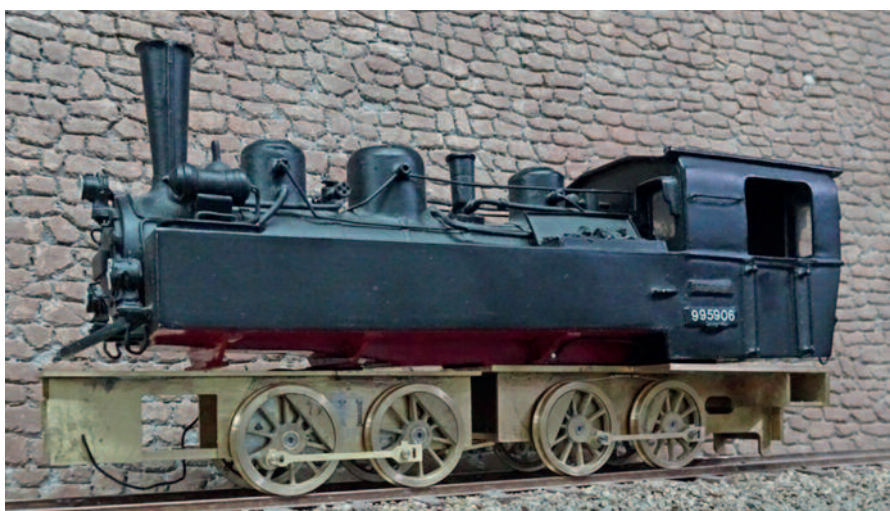
Erster Auftritt mit neuem Fahrwerk und Antrieb, alles inclusive Räder neu gebaut von Ulf Haußen.
