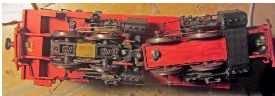
Eigentlich eine 2'B-Maschine mit dem um eine Achse gekürzten Antrieb einer Märklin H0 BR 23. Der Drehpunkt des Vorderwagens liegt kinematisch korrekt hinter der zweiten Achse. Im Modell muss so ein Vorderwagen ja noch freier schwenken können als beim Vorbild. Anstatt diesen ebenfalls zu motorisieren entschied sich Ulf Haußen für die Konstruktion eines kompletten neuen Fahrwerks.
