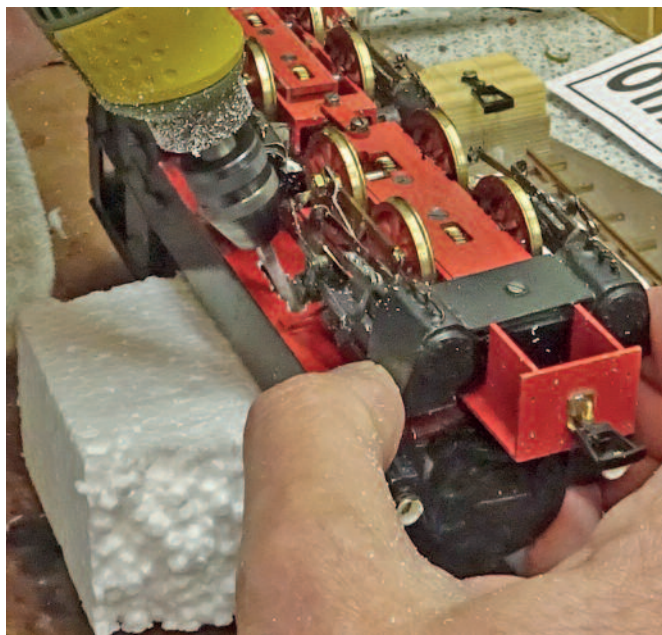
links und oben: Hier ist auch ein Spezialist am Werk. In das von unten in den Wasserkasten gefräste Loch füttert Jaffa einen von OOK geköpften Nagel nach dem anderen hinein.
