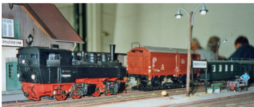
Drei Jahre später konnte in der gleichen Zeitschrift schon das fertige Modell gezeigt werden: die erste betriebsfähige 0m-Mallet nach deutschem Vorbild. Der Antrieb stammte von einer geschlachteten Märklin H0 BR 23, die Räder ebenfalls (jede zweite Speiche herausgesägt). Repros (2): OOK
